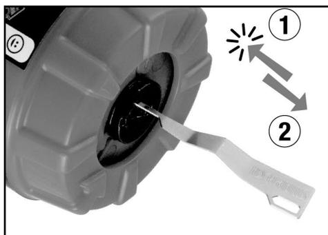
**A** Insérez l'outil SmartKey dans le petit trou (à côté du chemin de clé) situé sur la face du cylindre et poussez-le fermement pour le faire entrer jusqu'au fond, puis retirez l'outil SmartKey.
