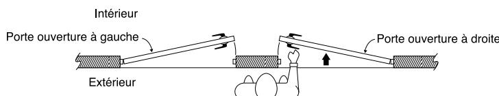
**REMARQUE :** le sens doit être indiqué pour les becs-de-cane inactifs et pour les serrures d'entrée à becs-de-cane à main gauche ou droite.
